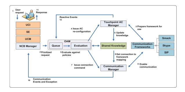
Figure 5.1: NCB Control Flow Diagram.
